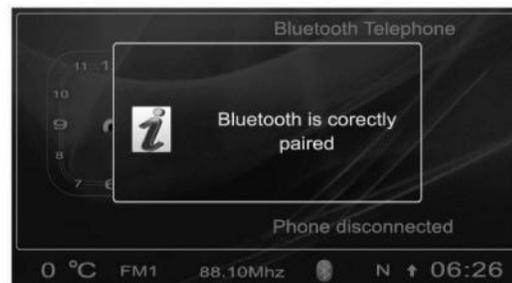
زمانیکه بلوتوث خودرو روشن می شود سیستم بصورت خودکار به دنبال آخرین تلفن همراه متصل شده به خودرو می گردد و در صورت عدم موفقیت در یافتن آن، طبق لیست تلفن های موجود در **pairing list** شروع به جستجو می کند. اگر باز هم موفق به برقراری ارتباط با آنها نشد (بلوتوث تلفن همراه خاموش است و یا تلفن همراه در ماشین نمی باشد) هیچ اقدام دیگری انجام نمی دهد. سیستم قابلیت نگهداری تا ۱۰ تلفن همراه را در حافظه خود دارد.
